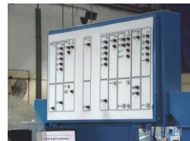
چراغها به میکرو سوئیچ و تایمر متصل شده است
